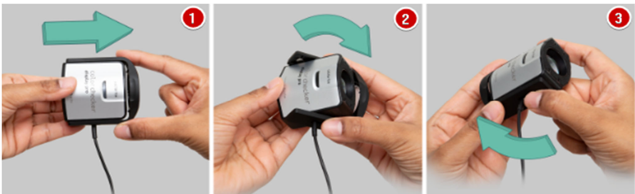
rys. 2.2-1 Zmiana konfiguracji pomiarowej kolorymetru Calibrite z konfiguracji do pomiaru oświetlenia otoczenia do konfiguracji do pomiaru światła emitowanego przez ekran monitora
