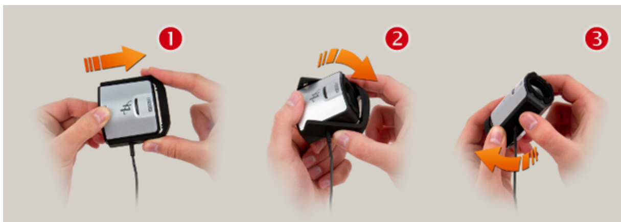
rys. 2.2-1 Zmiana konfiguracji pomiarowej kolorymetru i1 Display Pro z konfiguracji do pomiaru oświetlenia otoczenia do konfiguracji do pomiaru światła emitowanego przez ekran monitora
